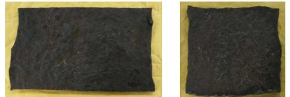
腐食鋼板 (サンプル1) 腐食鋼板 (サンプル2)
